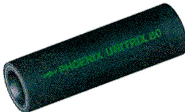
Universalschlauch zum Durchleiten von Benzin (kein bleifreies Benzin), Mineralöl, Gasöl, Kerosin, Heizöl und Schmierölen, Druckluft, Kalt- und Heißwasser mit und ohne Waschzusätzen, vegetabilen und tierischen Fetten, Propan, Butan, leichten Säuren, techn. Alkohol, Schädlingsbekämpfungsmitteln, Salzlösung, Teer, Naphta. Hohe Widerstandsfähigkeit gegen Ozon durch CR-Decke.
